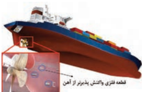
شکل ۱۲. چگونگی حفاظت کاتدی بدنه کشتی
