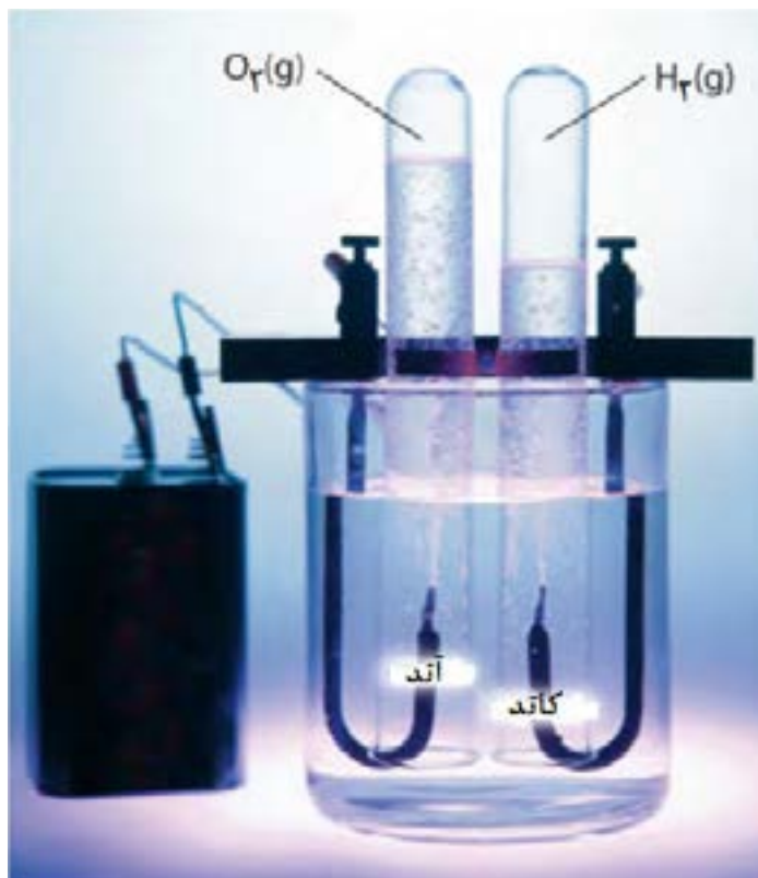
شکل ۸. دستگاه برقکافت آب
